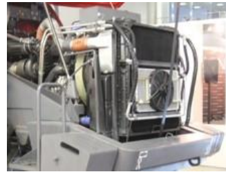
Радиатор с увеличенной водяной секцией и интеркулером (в комплектации «Премиум»)
