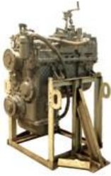
КПП с дополнительной (пятой) опорой
