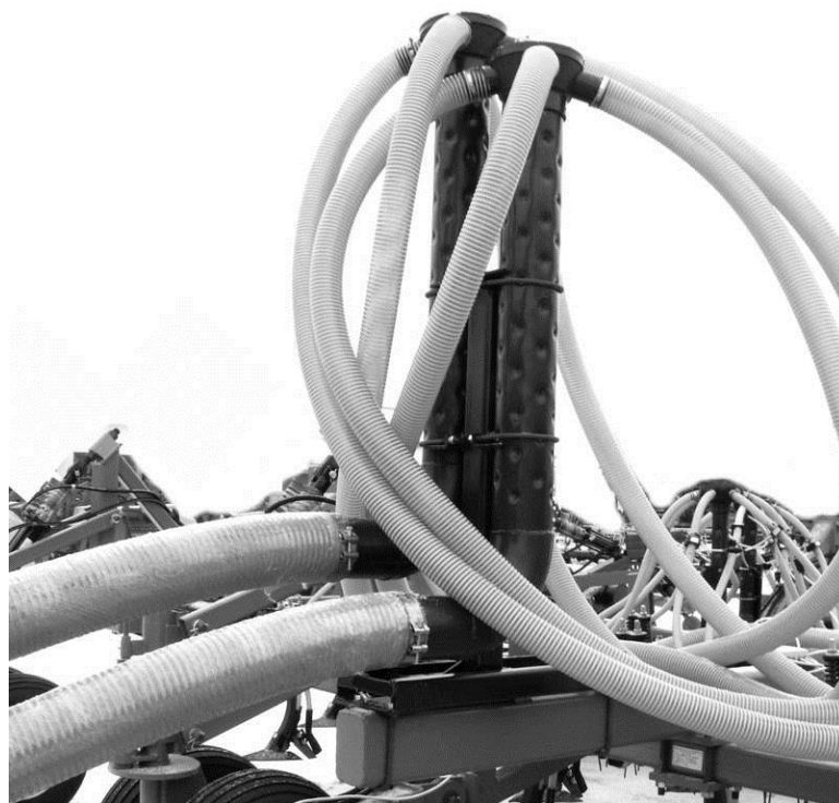
Рис. 4.13.2.1. Сборка первичного коллектора для ПК раздельным высевом семян и удобрений.
