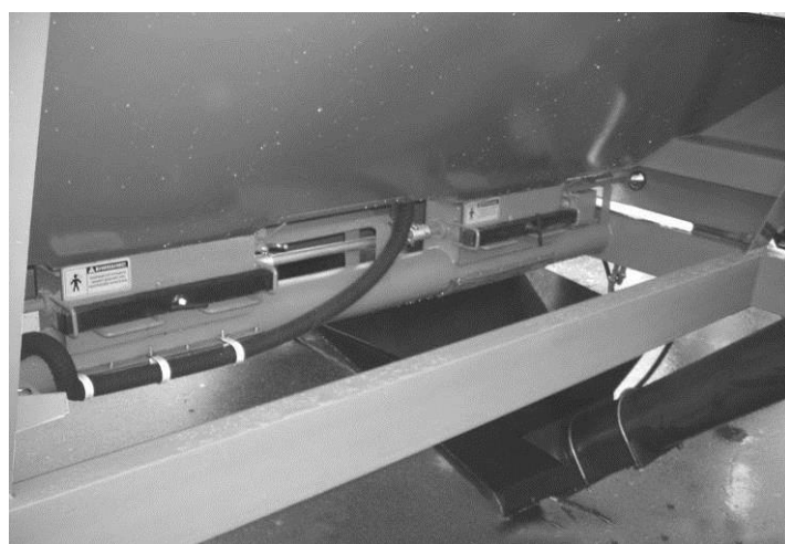
Рис. 6.5.5. Положение корзины шнека при разгрузке бункера
