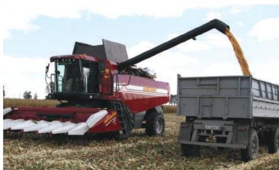
Система выгрузки зерна с верхним расположением выгрузного шнека позволяет быстро загружать зерном кузова автомобилей с высокими бортами, экономя время на уборке.
