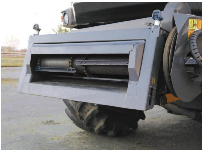
Реверс транспортёра наклонной камеры - без выполнения этой операции не обойтись, особенно в сложных условиях уборки. Применение гидромотора в конструкции наклонной камеры даёт возможность бесступенчато реверсировать транспортёр, экономя при этом время.
