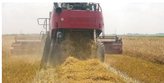
Если солому нужно сохранить для дальнейшего использования, измельчитель переключается на режим укладки валка. В этом режиме солома укладывается в рыхлые вспушенные валки, удобные для дальнейшего подбора.
