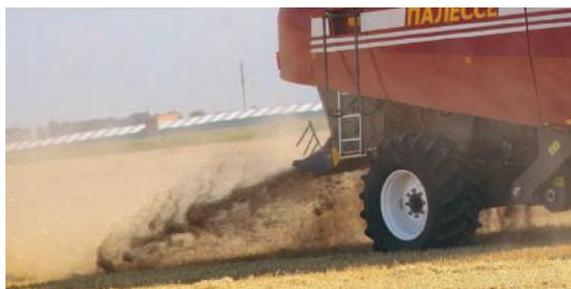
Соломоизмельчитель с увеличенным количеством ножей обеспечивает тщательную резку соломы и её равномерное рассеивание по полю на заданную ширину в качестве удобрения, создавая хорошую основу для будущего урожая.
