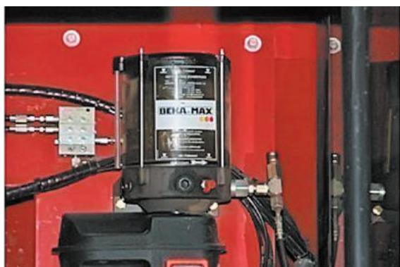
Использование автоматической централизованной системы смазки - это потрясающий резерв экономии времени на ежесменное техническое обслуживание, экономия смазки за счёт более точного дозирования автоматикой, увеличение срока работы смазываемых узлов и машины в целом.
